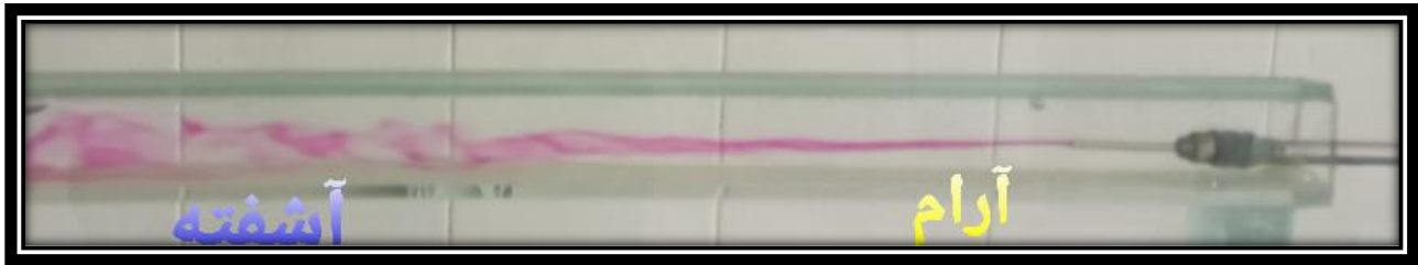
شکل (۲): انواع جریان در دستگاه رینولدز
