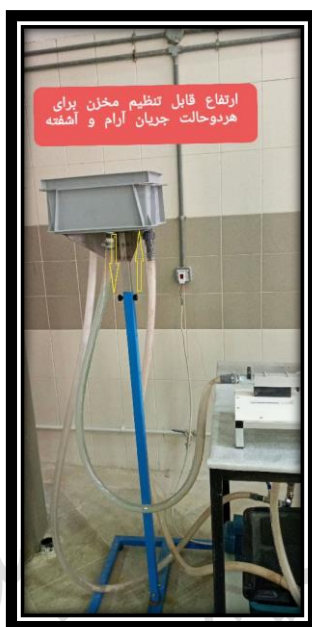
شکل (۵): مخزن آب تغذیه سیستم
