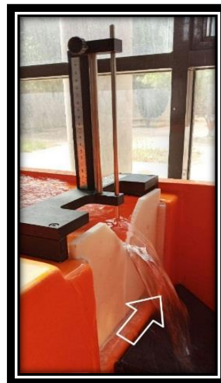
شکل (۴) : سقوط آزاد جریان روی سرریز مثلی
