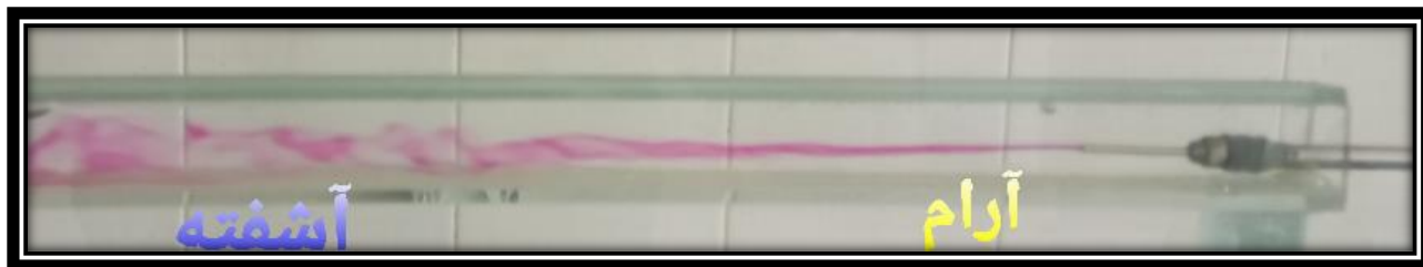
شکل (۲): انواع جریان در دستگاه رینولدز
